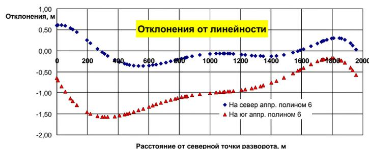
Рис. 3. Расчетные отклонения истинного продольного профиля дороги от средней прямой
