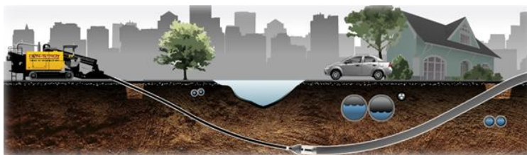
Рис. 1. Схема проведення горизонтально направлено буріння
