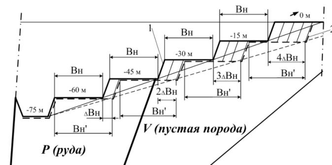
Рис. 1. Схема для определения взаимосвязи вскрышных работ и производительности карьера: 1 (-) и 2 (-) – положение рабочего борта карьера при работе с производительностью по руде  $A_p$  и  $A_p + \Delta A_p$ ;  $\Delta B_H$  – увеличение нормативной ширины рабочей площадки при увеличении производительности карьера по руде на  $\Delta A_p$ ;  $B'_H$  – нормальная ширина рабочей площадки при работе карьера с производительностью по руде  $A_p + \Delta A_p$
