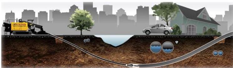
Рис. 1. Схема проведення горизонтально направлено буріння
