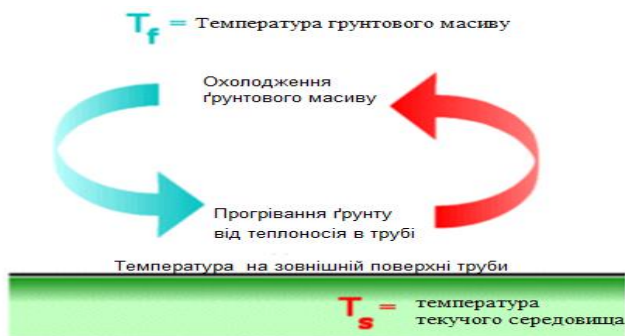
Рис. 7. Процес теплообміну в ґрунтовому масиві з комунікаційними мережами
