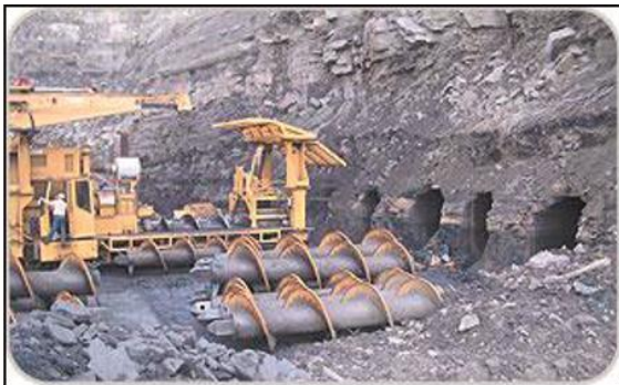
Рис. 6. Шнекова гірнична система.
