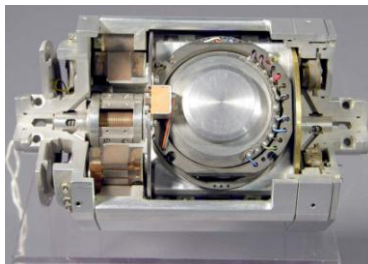
Рис. 1. Типовий інтегруючий гіроскопічний акселерометр 25 PIGA, Titan II
