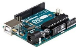
Рис. 1. Плата Arduino UNO R3 на мікроконтролері ATmega 328
