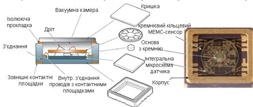
Рис. 1. Схема гіроскопічного акселерометра
