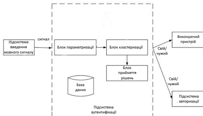
Рис. 1. Структура комп'ютеризованої системи контролю доступу
