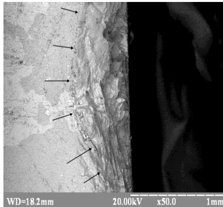
Рис. 4. Деформація в моделі з пластиною товщиною 2 мм
