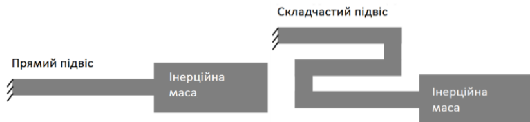
Рис. 1. Можлива форма пружних підвісів
