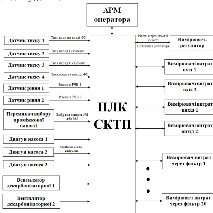
Рис. 1 Структурна схема автоматизованої системи контролю параметрів фільтрувальної станції водоканалу
