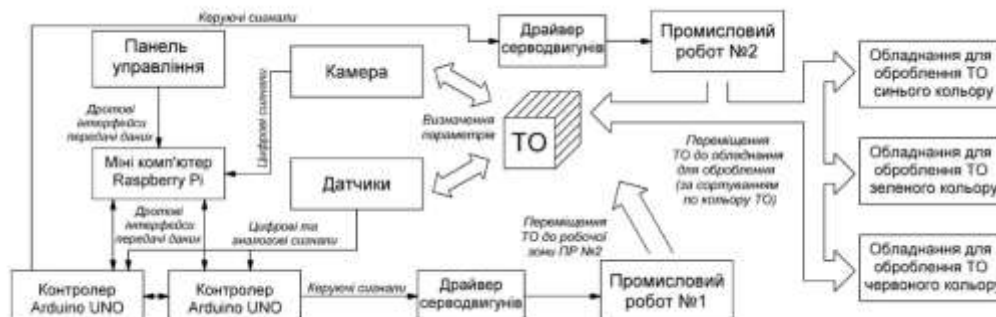
Рис. 1. Спрощена структурно-функціональна схема стенда сортування ТО за кольором
