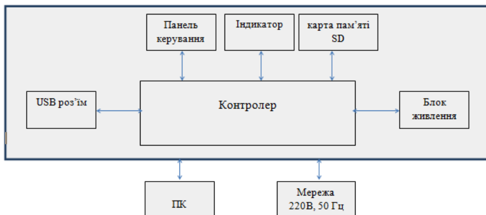
Рис. 1. Структурна схема реєстратора
