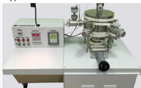
Рис. 2. Установка для повірки вакуумметрів
