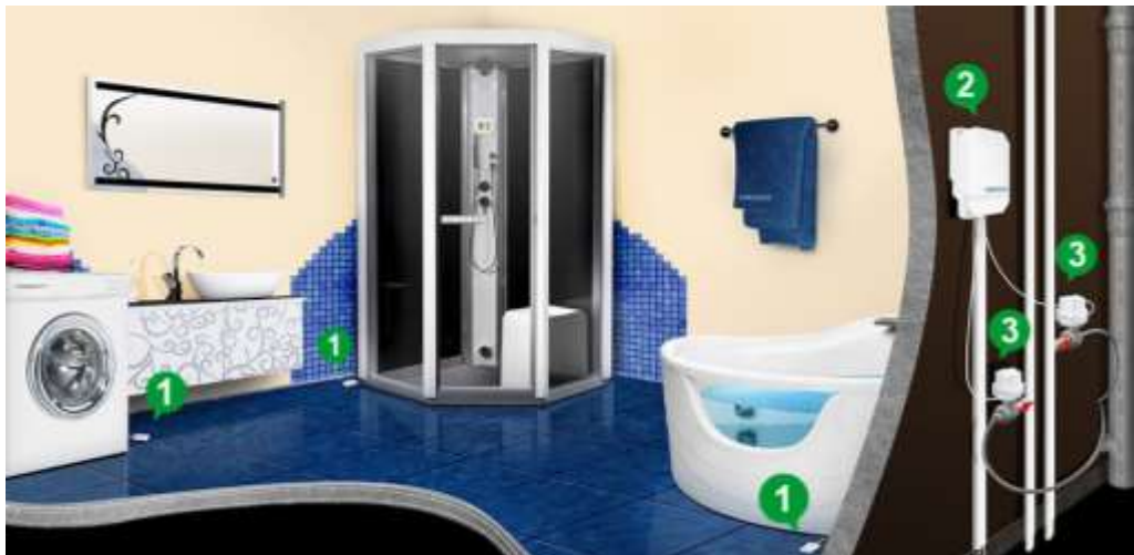
Рис.1. Схема розміщення елементів системи: 1- датчик протікання води; 2 – блок керування; 3 – електроприводи
