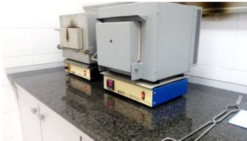
Рис. 1. Нагрівання зразків природного каменю у муфельних печах
