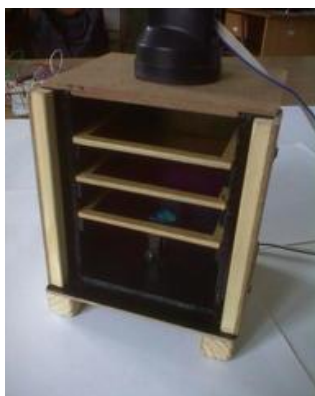
Рис. 3. Лабораторний макет зі встановленими у ньому трьома світлофільтрами
