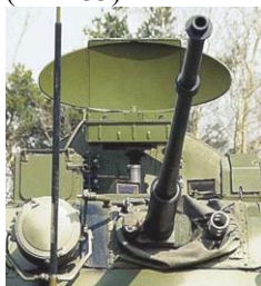
Рис. 1. Модернізована РЛС «Кредо-М» у складі БРМ-3К
