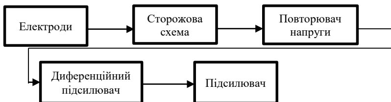
Рис.1. Структурна схема електрокардіографічного підсилювача медичного монітора
