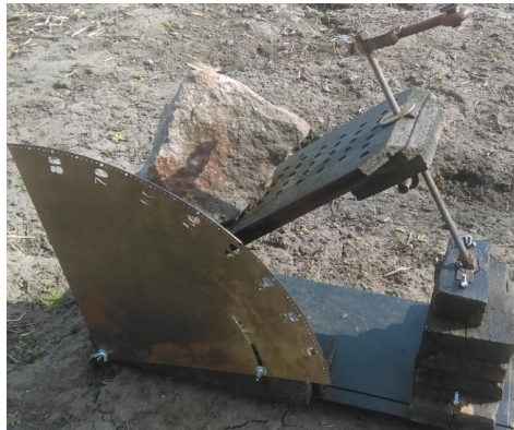
Рис. 1. Стенд – прилад для задання необхідного нахилу зразків
