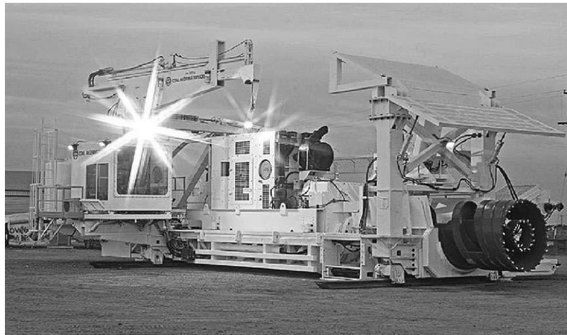
Рис. 1. Шнекобурова машина (ШБМ)
