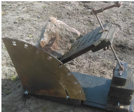
Рис. 1. Стенд – прилад для задання необхідного нахилу зразків
