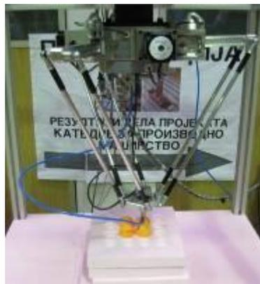
Рис. 9. ДЕЛЬТА-механизм с поворачивающимися шарнирами
