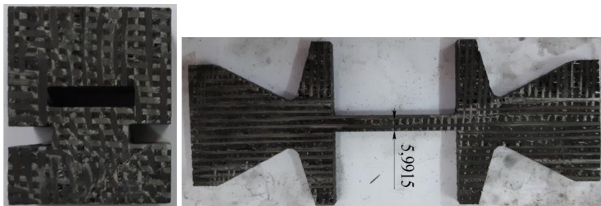
Рис. 3. Фото отриманих зразків для механічних випробувань
