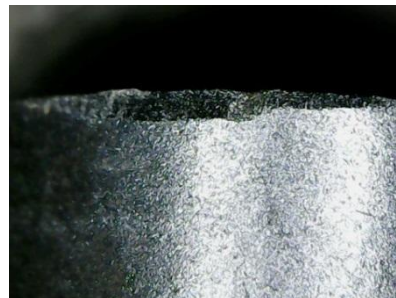
Рис. 2. Контактні ділянки передньої (а) і задньої (б) поверхонь інструменту з нанокompозитом «алмаз-WC» після точіння твердого сплаву ВК15 ( v = 36 м/хв; S = 0,14 мм/об; t = 0,2 мм)
