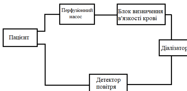
Рисунок 1 – Структурна схема блоку визначення в'язкості крові
