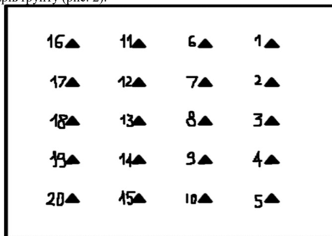
Рис. 1. Схема розташування точок для відбору зразків ґрунту при 20-ти кратній повторності
