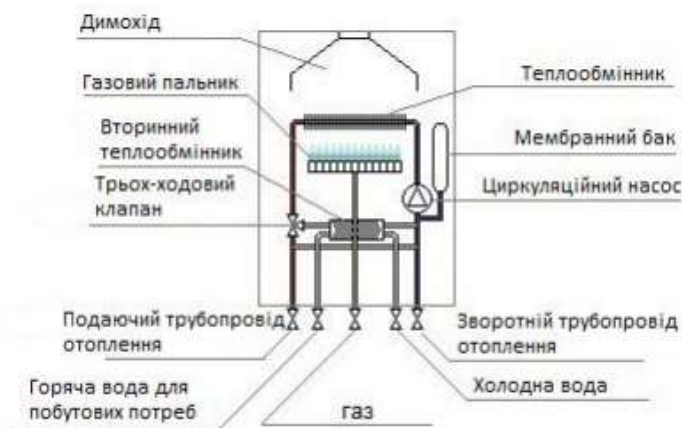
Рис. 1. Будова газового котла
