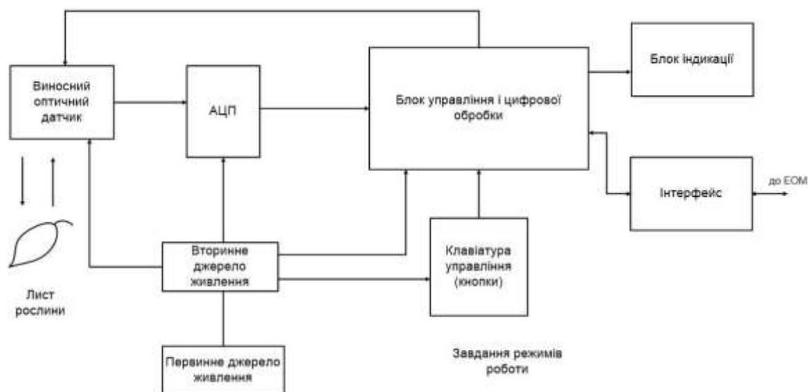
Рис. 1 Структурна схема приладу для експрес - діагностики стану рослин
