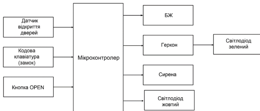
Рис. 1 . Структурна схема системи охорони для офісного приміщення
