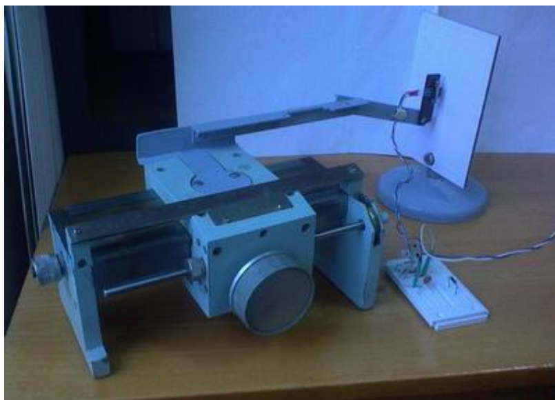
Рис.3.Лабораторна установка для дослідження відбивних властивостей оптопари
