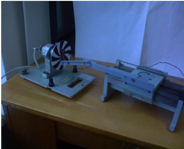
Рис. 1. Лабораторна установка для дослідження тахометричного перетворювача на базі відбивної оптопари
