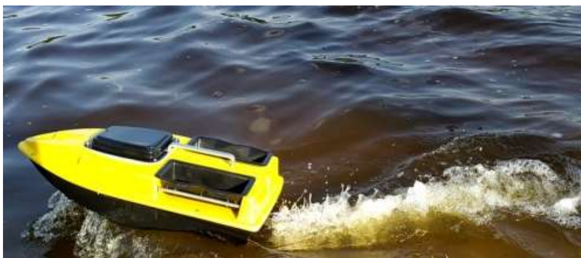
Рис. 2. Макет розробленої автоматизованої мобільної платформи для проведення геодезичних досліджень водойм
