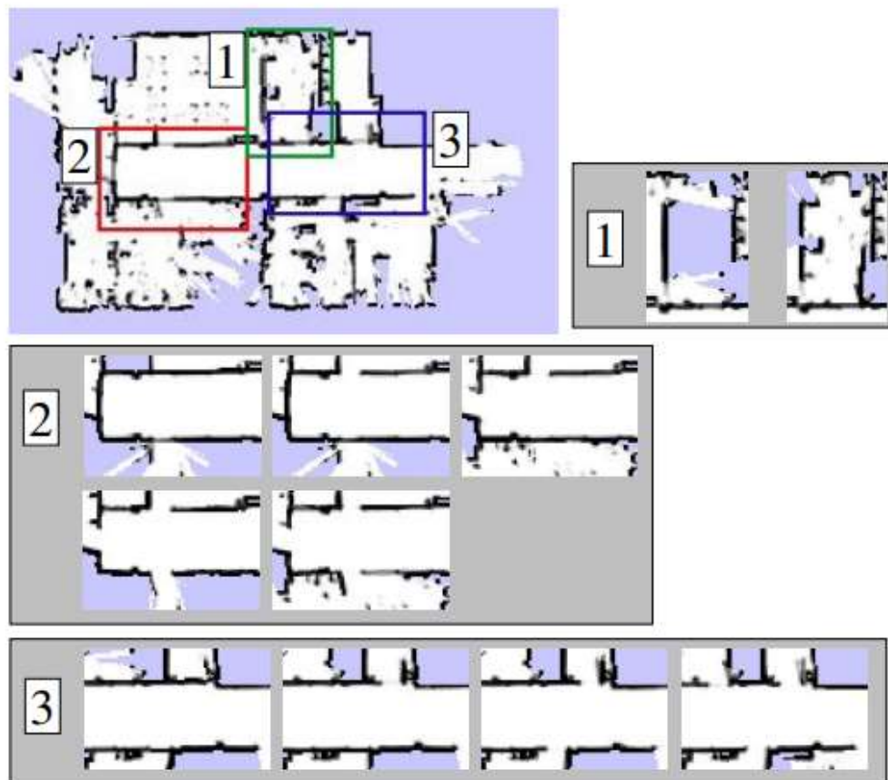
Рис. 2. Мапа з клаптиків, що представляє різні конфігурації, засвоєні для окремих під-мап в типовому офісному середовищі
