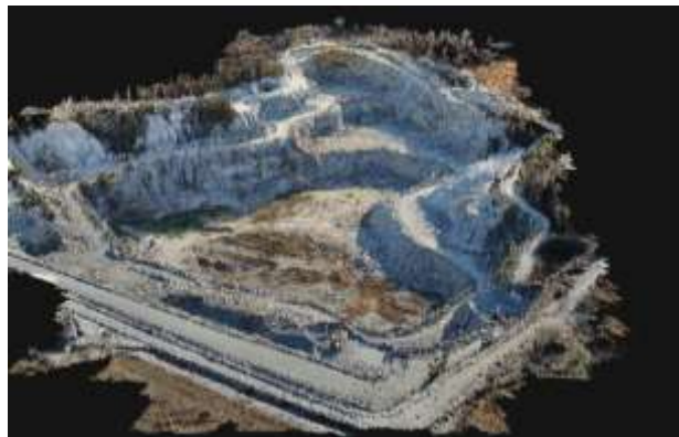
Приклад отримання 3D- Моделі кар'єру за допомогою якісного виконання зйомки і посткамеральної обробки, виконуючи усі вимоги
