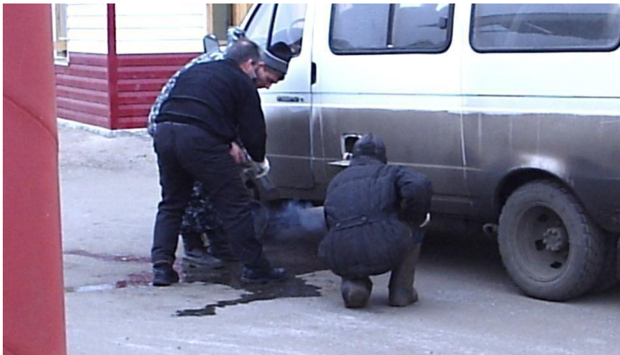
Рис. 1. Фрагмент аварійної ситуації, що виникла в результаті відмови ЗПА автомобільного газового балона
