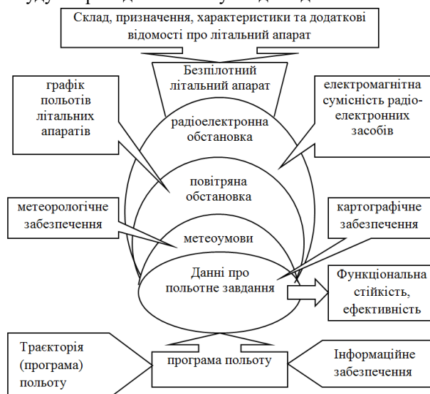
Рис. 1. Функціональна схема роботи безпілотного літального апарата
