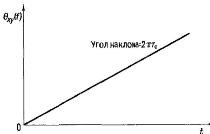
Рис. 1. Модель зависимости разностного фазового спектра от задержки сигналов
