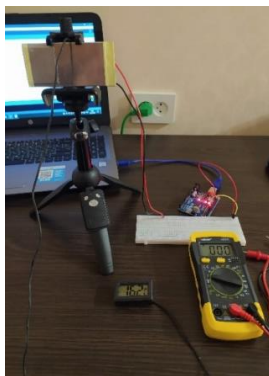
Рис.1. Модель пристрою осушення повітря в закладах охорони здоров'я та зовнішній вигляд елемента Пельтьє
