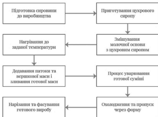
Рис. 1. Стадії технологічного процесу виробництва ірисної маси
