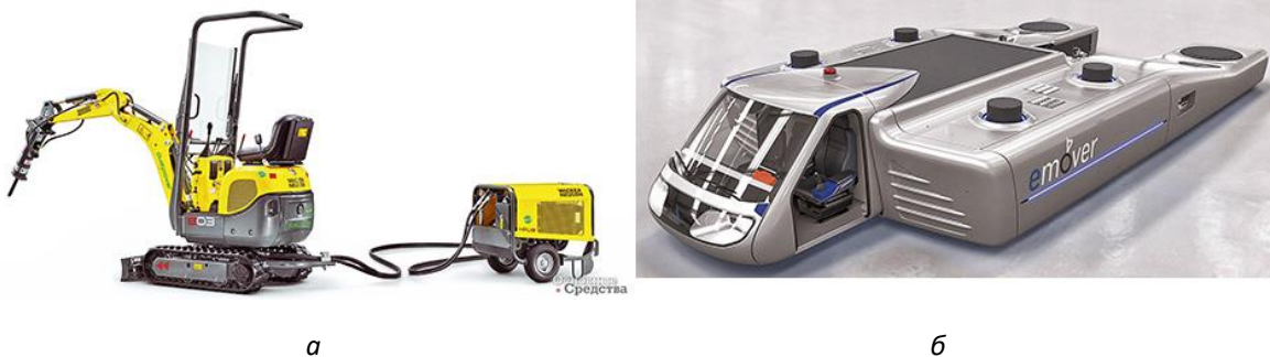
Рисунок 1. Спеціалізовані машини з електричною силовою установкою: а - мініекскаватор з зовнішнім електрогенератором для роботи в закритих приміщеннях; б - аеродромний тягач.
