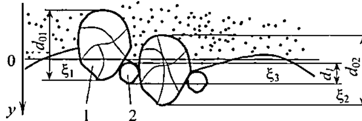
Рис. 2. Схема робочої поверхні круга 1 – абразивне зерно; 2 – часточка шламу
