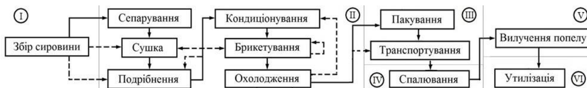
Рис. 1. Схема життєвого циклу паливних брикетів (загальний вигляд). Етапи: I – довиробничий, II – виробнича діяльність, III – доставка продукту; IV – споживання, V – вилучення попелу VI – утилізація
