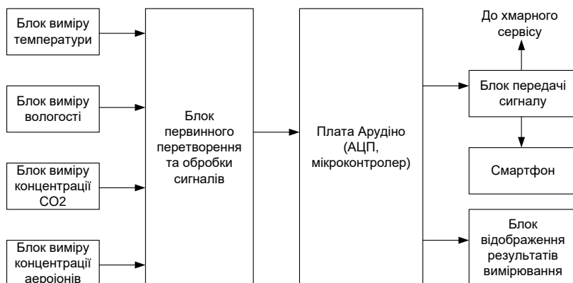
Рис. 1. Структурна схема системи моніторингу якості повітря
