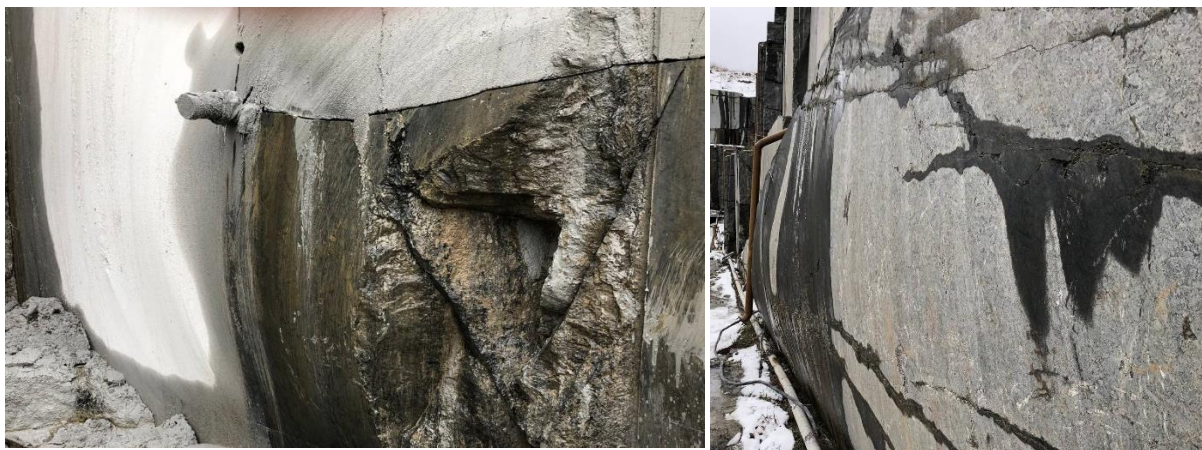
Рис. 1. Викривлення поверхні блоку при розпилюванні зношеним канатом на Невіривському родовищі лабрадориту
