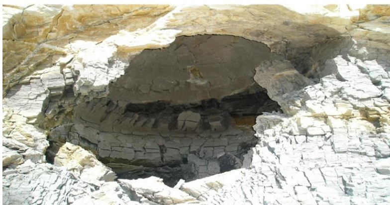
Рис. 2. Газова порожнина в різноміцнісному гірському масиві
