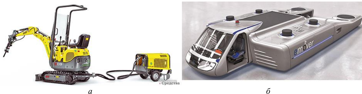
Рисунок 1. Спеціалізовані машини з електричною силовою установкою: а- мініекскаватор з зовнішнім електрогенератором для роботи в закритих приміщеннях; б- аеродромний тягач.
