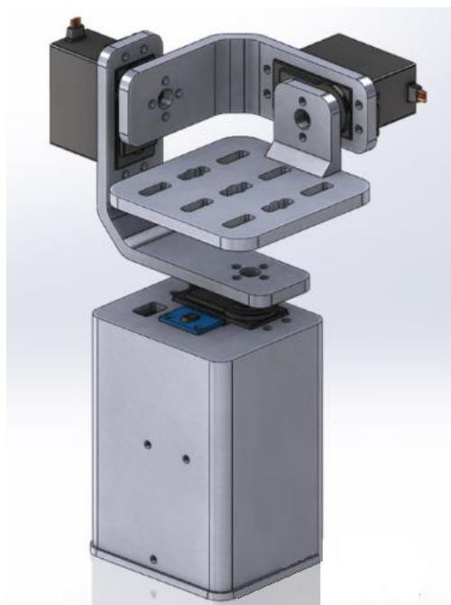
Рис. 1. Загальний вигляд трьохосової стабілізуючої платформи
