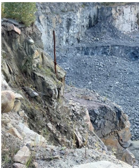
Рис. 3. Заклинена бурова штанга в шарі флювіогляціальних відкладів на кар'єрі Соснівського родовища гранітів
