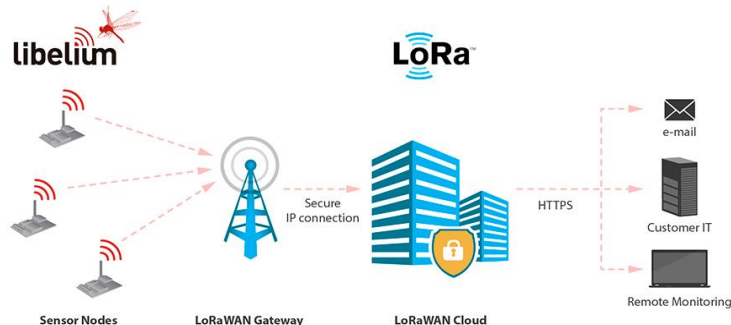
Рис. 1. Архітектура системи LoRa
