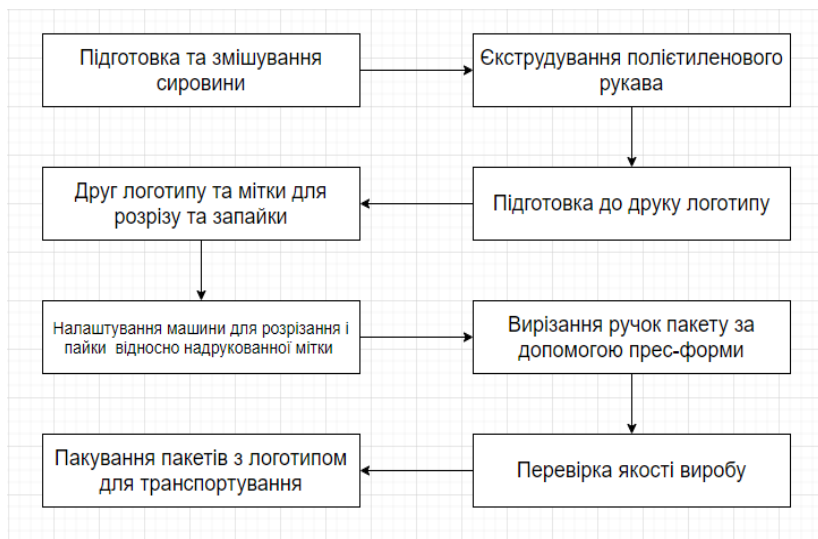
Рис.1. Стадії технологічного процесу виробництва пакетів з логотипом
