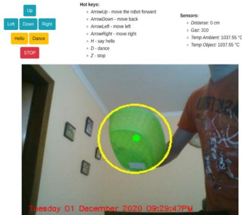
Рис. 1. Веб-інтерфейс для дистанційного керування робота-гексапода
