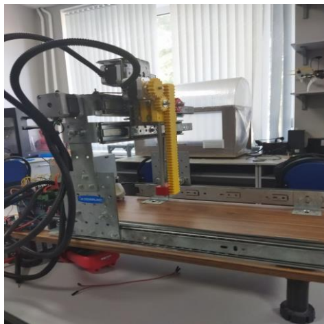
Рис. 1. Зовнішній вигляд автоматизованої системи посадки та вирощування рослин
