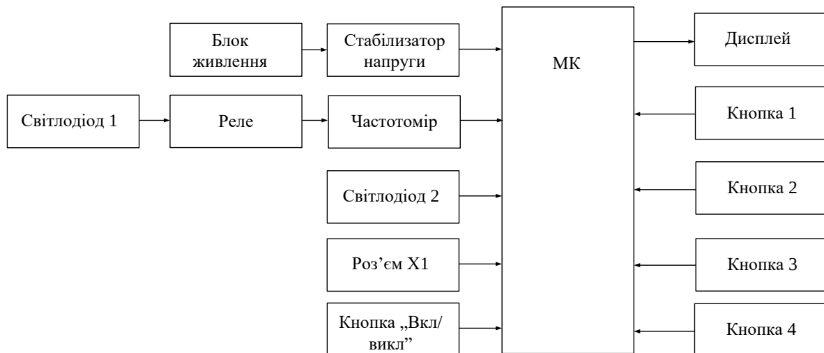
Рис. 1. Структурна схема комп'ютеризованої системи вимірювання ємності та індуктивності компонентів електронних схем
