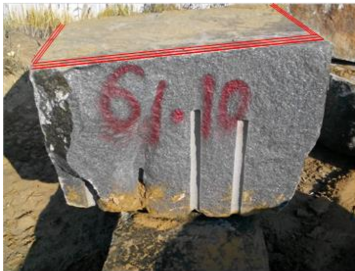
Рис. 1 Схема відбирання зразків для дослідження впливу вибуху на блок природного каменю
